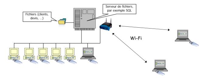
Réseau en entreprise avec serveur d'application (terminal/serveur) et accès à distance via Internet + commerciaux avec un portable indépendant
